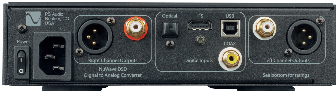
Zur maximalen Kanaltrennung liegen die beiden analogen Ausgänge so weit wie möglich auseinander. Die vier Eingänge sitzen leicht erreichbar in der Mitte der Rückseite
